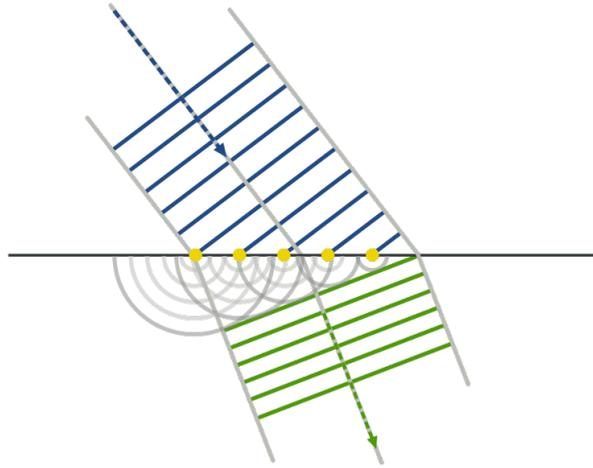
Abbildung 3: Brechung beim Medienwechsel
