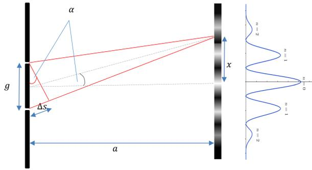
Abbildung 7: Darstellung der Interferenz am Doppelspalt auf einer geraden Projektionsfläche
