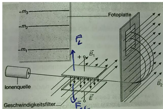
Abbildung 14: Der Aufbau des Massenspektrometer (Schematisch)
