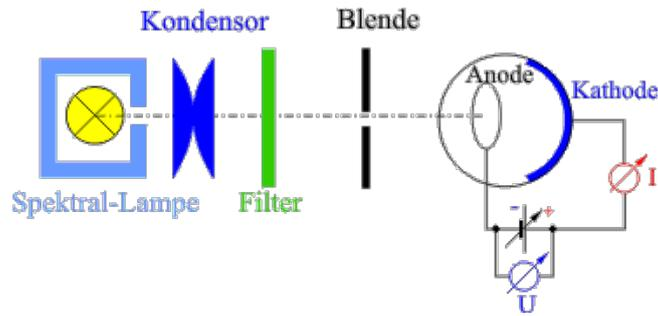
Abbildung 15: Der Aufbau der Gegenfeldmethode (Schematisch)
