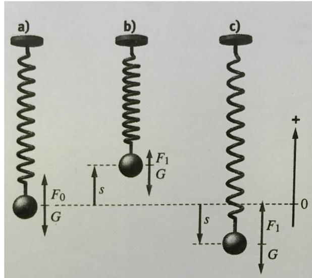
Abbildung 5: Das Federpendel mit der Auslenkung  $s$
