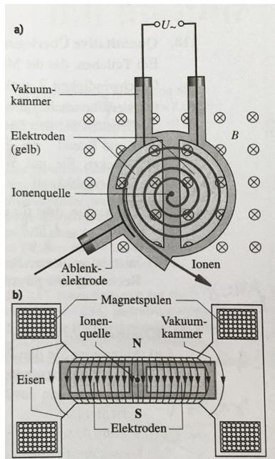
Abbildung 13: Das Zyklotron (Schematisch)
