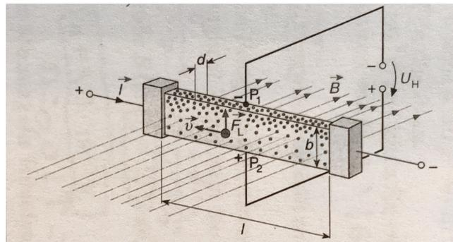
Abbildung 11: Der Halleffekt (Schematisch)
