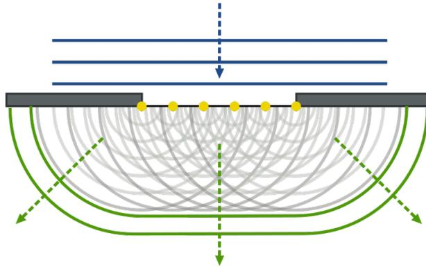
Abbildung 2: Beugung am Einzelspalt
