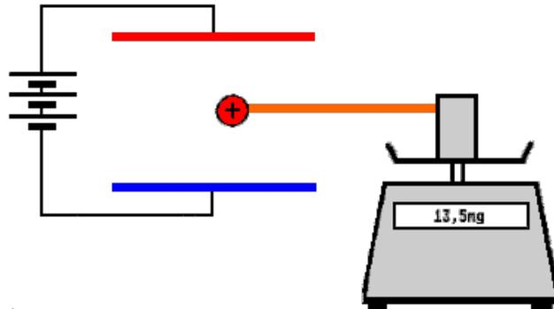
Abbildung 9: Elektrische Feldstärke wiegen.
