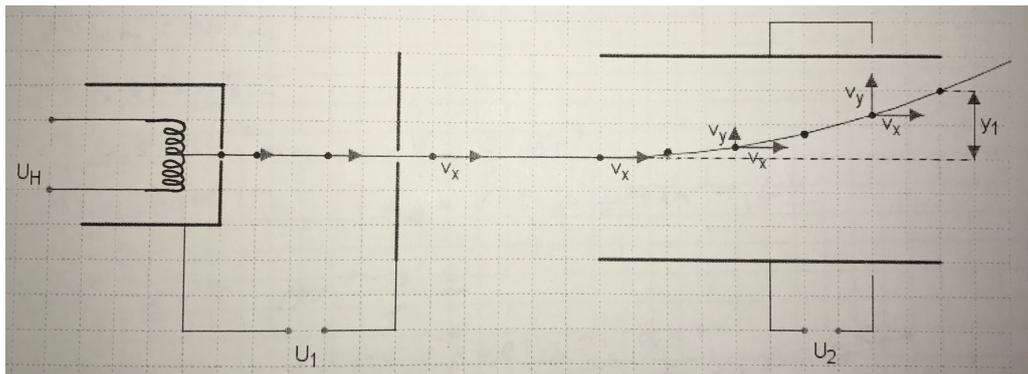
Abbildung 10: Die Elektronenstrahlröhre
