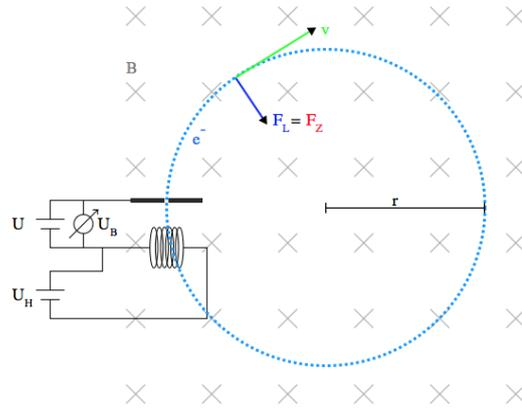
Abbildung 12: Das Fadenstrahlrohr (Schematisch)
